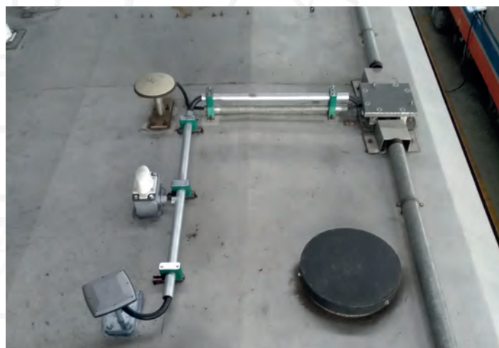
Antennák a műholdjelek és a DGNSS/RTK korrekciók vételéhez
