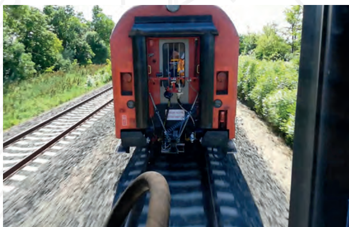
IC-személykocsi lekasztásos féktűmérése
