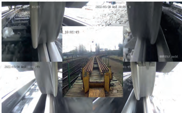
Hosszúsínszállító szerelvény siklásbiztonsági vizsgálata
