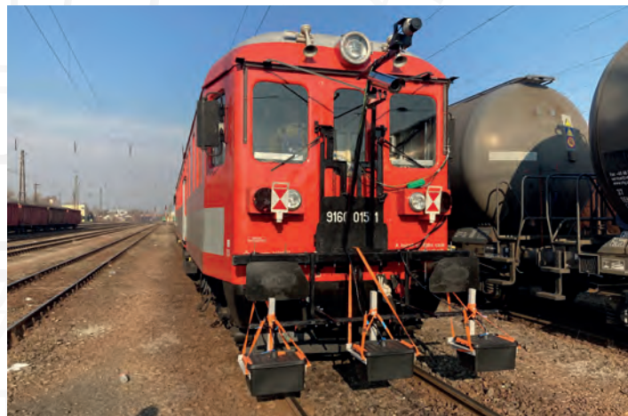
A GPR mérőrendszer mérővonatra szerelve
