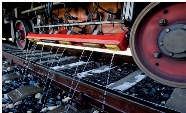
Mérő forgóváz az ultrahangos vizsgáló fejekkel
