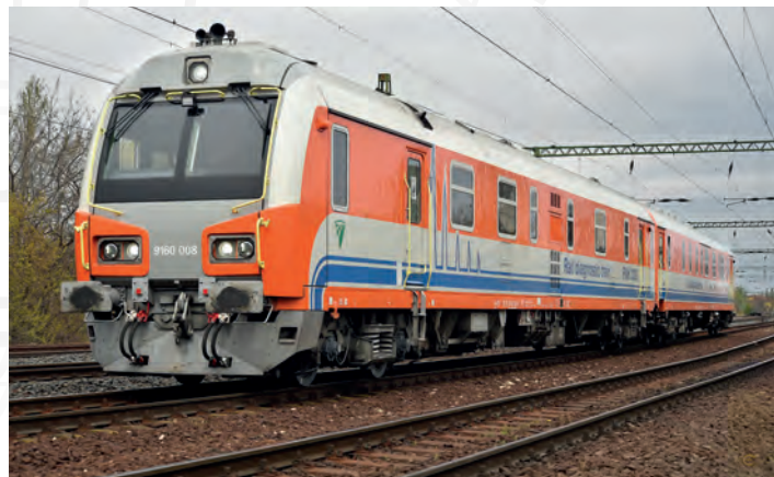
Síndiagnosztikai szerelvény (FMK-008)
