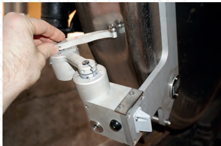
Kerékprofil és kerékátmérő mérése
