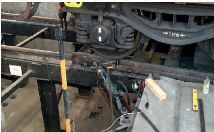
Teherkocsi forgóvázának kifordítónyomatékmérése
