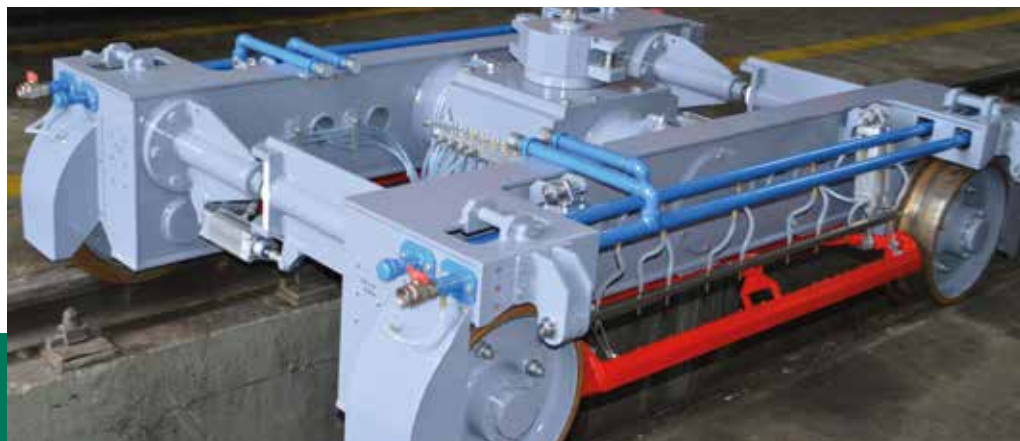
FMK-008 síndiagnosztikai szerelvény mérő forgóváza
