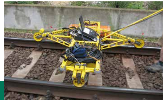
Vasúti pálya georadaros kézi mérése
