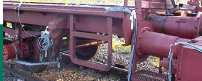
Kvázistatikus siklás elleníves próbapályán
