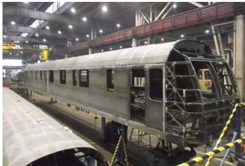
Mérőkocsi járműszerkezetének kivitelezés közben
