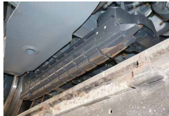
Részlegesen bekoptatott mágneses sínfék a vizsgálatosorozat előtt
