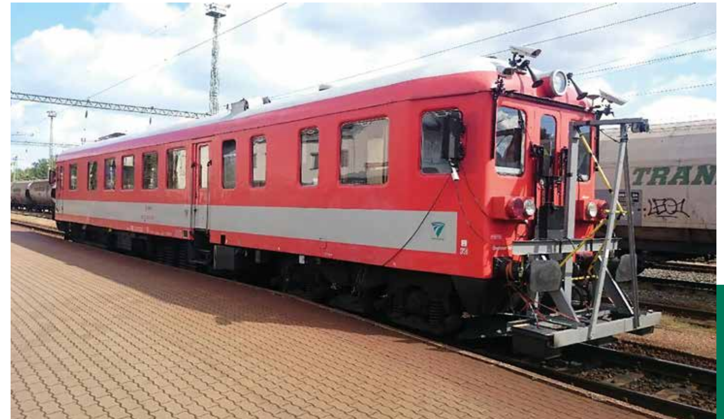
Gépi georadaros mérés vasúti pályán Ab-15 motorkocsival
