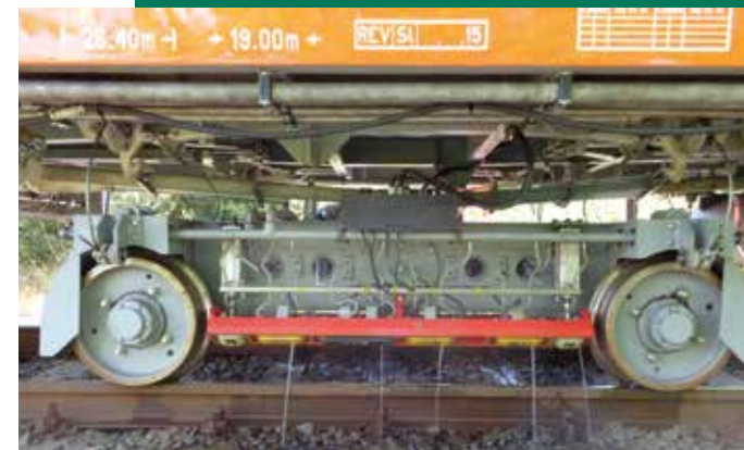
FMK-008 síndiagnosztikai szerelvény – mérőkocsi (mérőterem, ideiglenes operátori munkapult, mérő forgóváz, örvényáramos mérőfejek)
