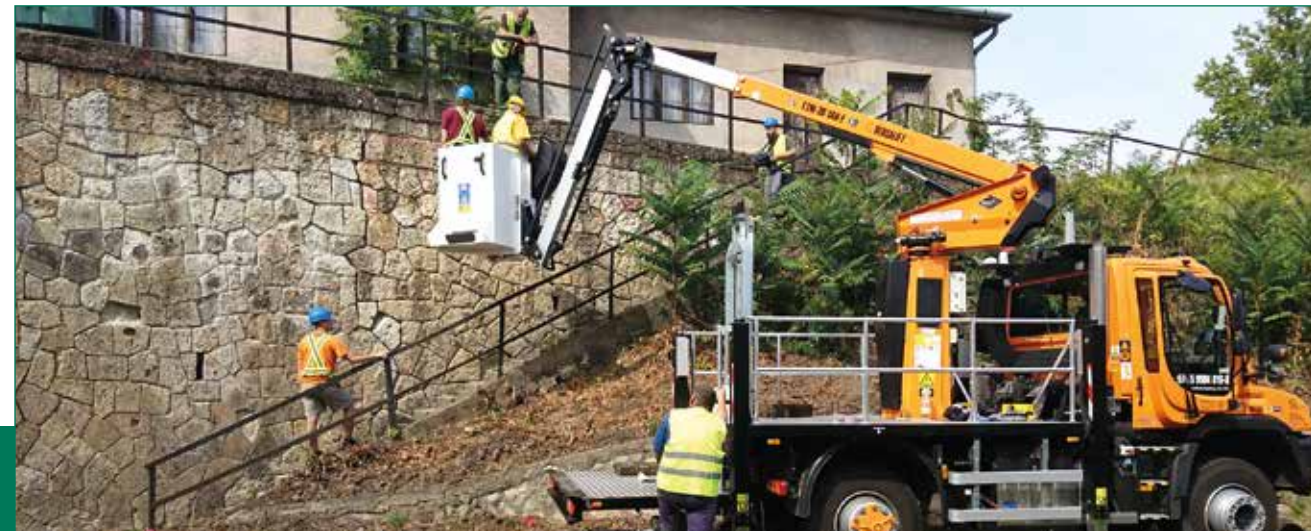
Támfalszerkezet georadaros vizsgálata
