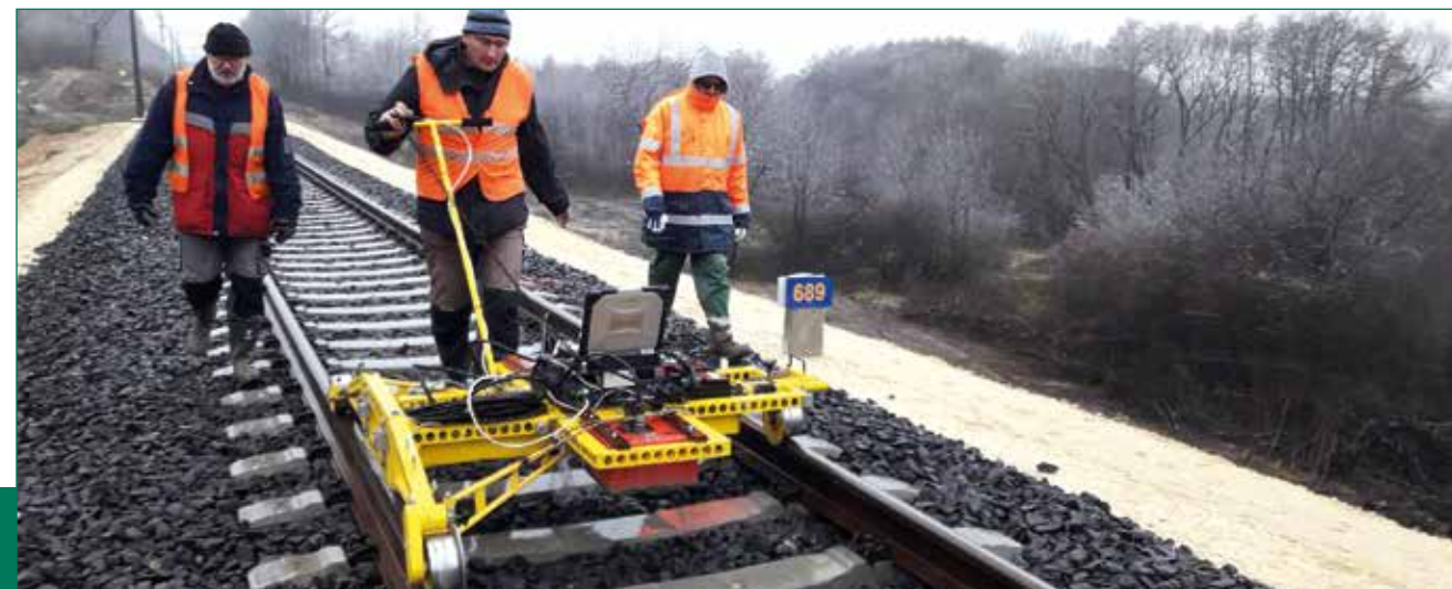
Kézi kiskocsis georadaros mérés
