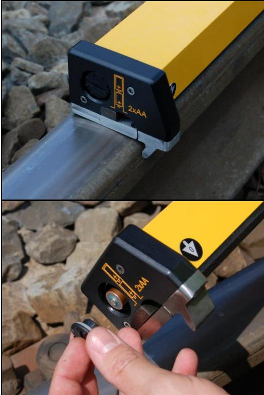
Fig. Nr. 2.2 Replacement of batteries
